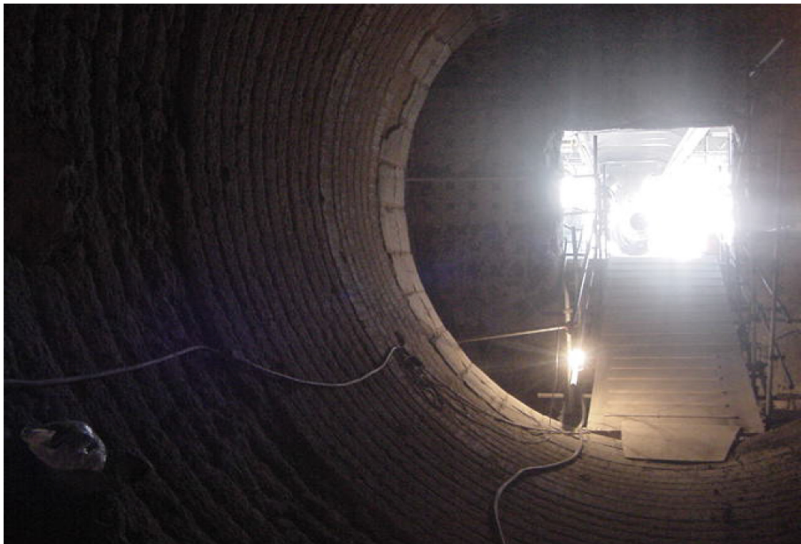
Figura 3.8 – Forno sem Formação de Colagem Fonte: Souza (2009).
