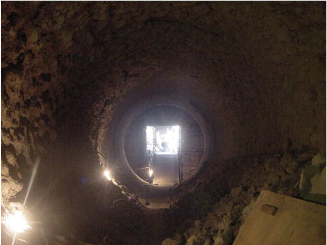
Figura 3.9 – Forno com Colagem normal na Zona de Queima Fonte: Souza (2009).
